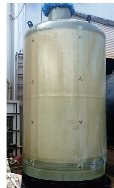
▲“ELEXIO”複合型縦置円筒型地下タンク試作品
